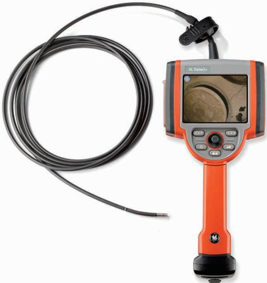
借助 XL Detect 和 XL Detect+ 工业内窥镜，让细节无处遁形。借助卓越的图像质量和 XL Detect+ 上的升级版 5 英寸 LCD 屏幕，提高准确性并加快检测速度。坚固耐用，降低维护成本。随时随地享有 GE 专业支持。轻巧便携、易于使用的设备。以实惠的价格获得您所需的高端功能。
