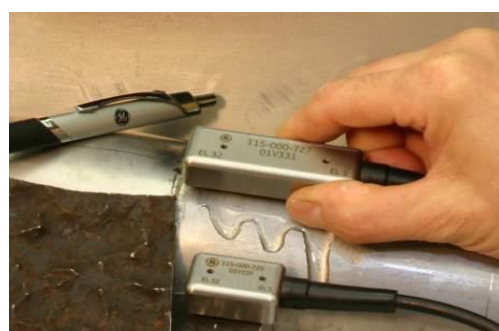
DM双晶相控阵探头 用于检测最薄0.8mm复合材料
